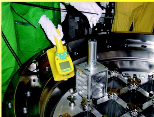
CoMo със специален детектор (4 активни повърхности детектора) за проверка за замърсяване на FE-хранилище за съхранение
